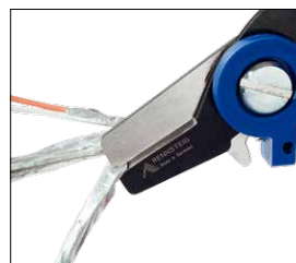
Schneiden der Paarschirmung Cutting the double shielding
